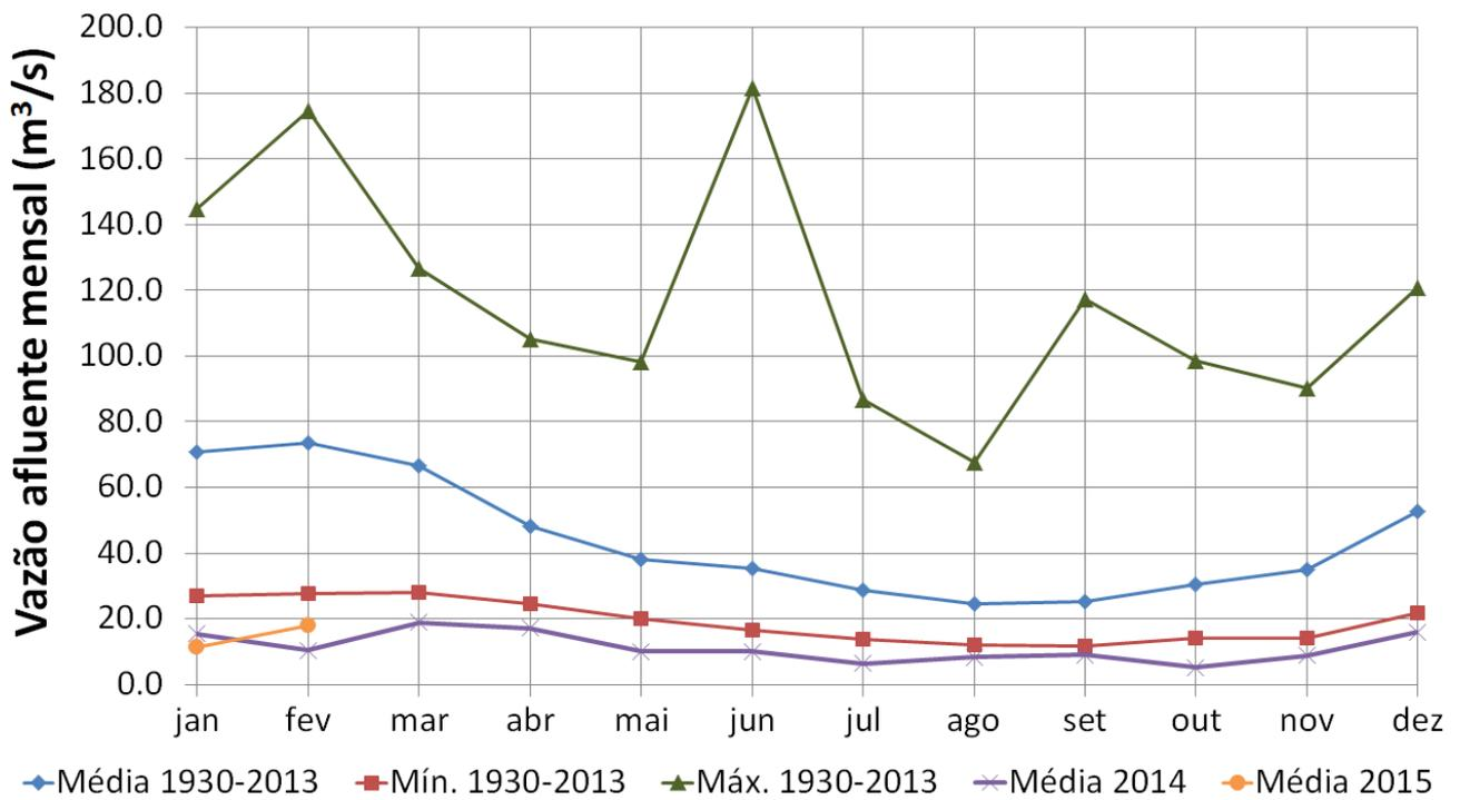
Figura 2. Vazão afluente (em  $m^3/s$ ) do Sistema Cantareira (Sistema Equivalente + Paiva Castro). A linha laranja refere-se à vazão média mensal até 05 de fevereiro de 2015 e a roxa à vazão média mensal de 2014. A linha em azul corresponde às vazões médias mensais para o período 1930 – 2013. As linhas verde e vermelha referem-se, respectivamente, aos máximos e mínimos absolutos da série histórica mensal no período 1930 – 2013.
