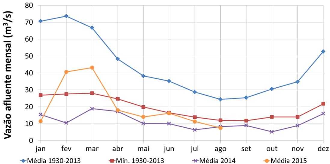
Figura 2. Vazão afluente (em  $m^3/s$ ) do Sistema Cantareira (Sistema Equivalente + Paiva Castro). A linha laranja refere-se à vazão média mensal até 05 de agosto de 2015 e a roxa à vazão média mensal de 2014. As linhas em azul e vermelho correspondem, respectivamente, às vazões médias mensais para o período 1930 – 2013 e aos mínimos absolutos da série histórica mensal no período 1930 – 2013.
