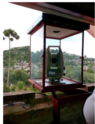
Figura 1 – ETR posicionada dentro da cúpula, por sua vez posicionada sobre base de centragem forçada, dentro do local de instalação.
