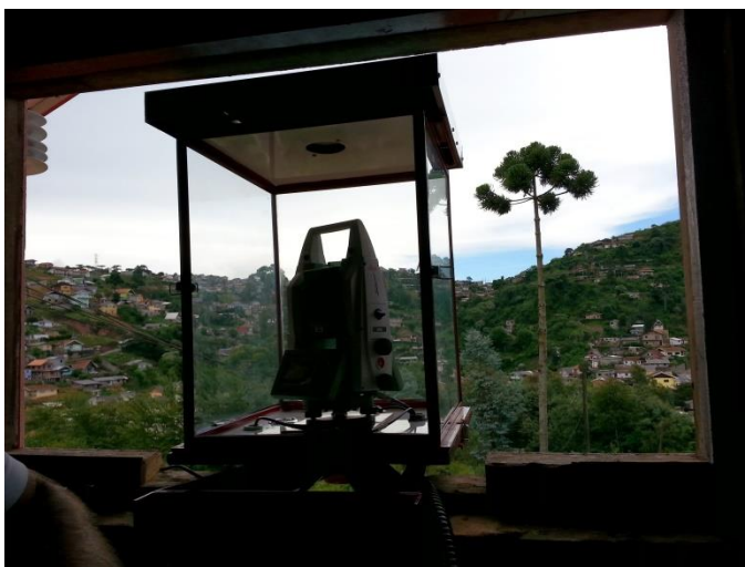
Figura 1 – ETR posicionada dentro da cúpula, por sua vez posicionada sobre base de centragem forçada, dentro do local de instalação.
